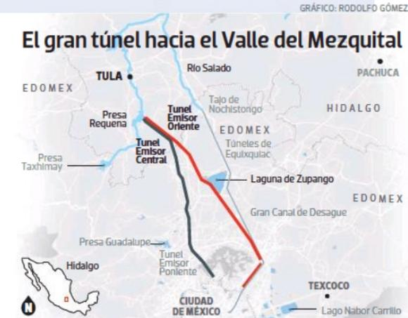
por eso saber cuánta lluvia hubo y hay ayuda a conocer con precisión cuánto se deben limitar las salidas de agua del Túnel Emisor Central y del Túnel Emisor Oriente, drenajes profundos construidos para evitar inundaciones en el Valle de México.
